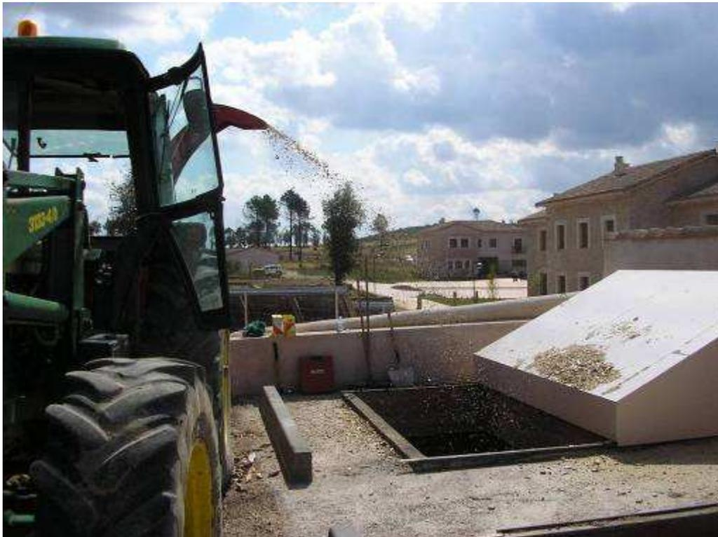
Carga de los silos de almacenamiento de la biomasa desde la astilladora
